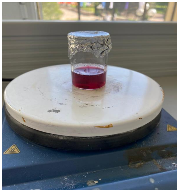
22 сурет - Полимер мен кобальт нитраты ерітіндісін дайындау
